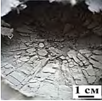
Рис. 20. Разрушение керамики «Идеал»
